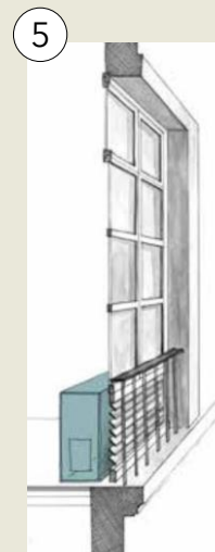
Exemple de sortie d'air conditionné camouflé dans la menuiserie Source : CAUE30
